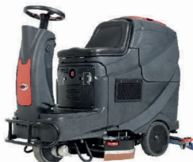
CODICE AS850R 50000552 PRODU. 4000 MQ/H PISTA 350 MM SERBATOI 120/120 LT
