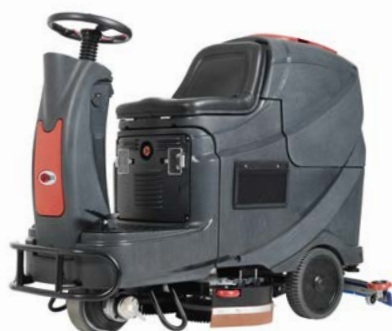
CODICE AS850R 50000552 PRODU. 4000 MQ/H PISTA 350 MM SERBATOI 120/120 LT
